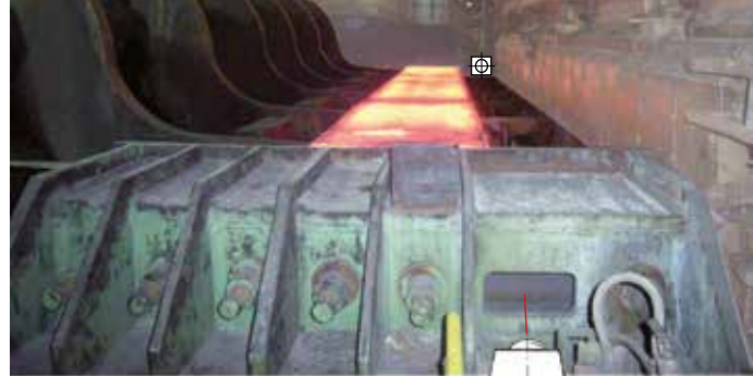
Längenmessung vor dem Hubbalkenofen
